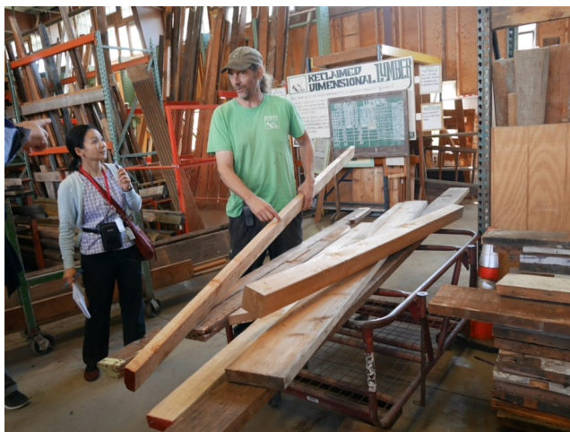
かつての実寸 2x4 と現在の呼称上の 2x4 (実寸は 1.5x3.5) のサイズと年輪の比較の説明 (参加者が撮影)
