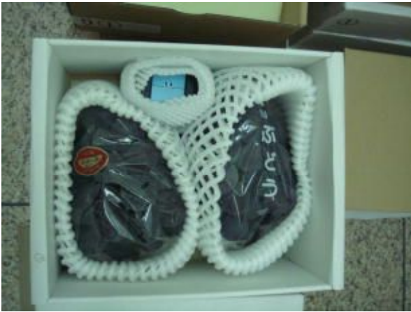
写真1 衝撃振動計測器設置 (上部中央の青色の機械)
