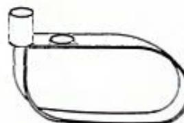
材質 バンド プラスチック(2.4mm) カバー プラスチック(1.5mm)
