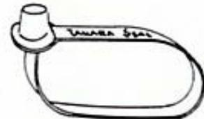
材質 **バンド** カラー鉄板(0.27mm) **カバー** アルミ(0.4mm)
